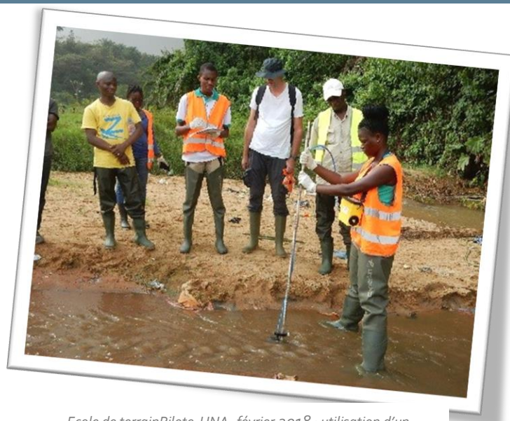
Ecole de terrainPilote UNA- février 2018 : utilisation d'un courantomètre pour effectuer des jaugeages.
